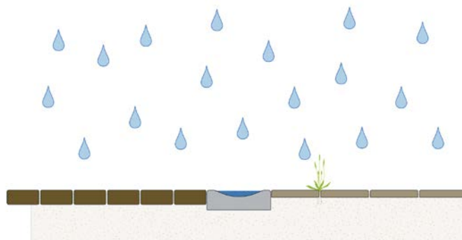
Schematische doorsnede bovengrondse afvoer | © atelier GROENBLAUW
