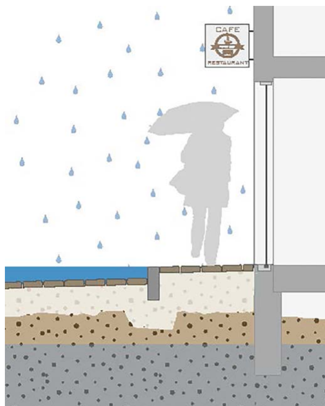
Schematische doorsnede verhoogd trottoir | © atelier GROENBLAUW
